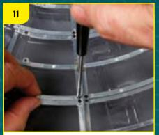
Зафиксируйте угол рамы TF-38, закрутив винт во фланец ребра жесткости.
