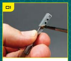
Зафиксируйте соединительную накладку ребра жесткости с помощью двух винтов.
