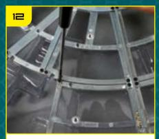
С помощью соединительной накладки с двумя отверстиями соедините угол рамы TF-39 с ребром рамы TF-40.
