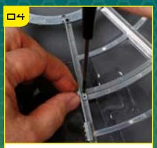
Закрутите два винта во фланец ребра жесткости на стыке рам TF-37 и TF-36.
