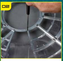
Ослабьте винт, фиксирующий угол рамы TF-37 на кольце турели.
