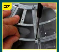
Зафиксируйте угол рамы TF-40, закрутив винт во фланец ребра жесткости.
