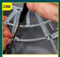
Зафиксируйте накладку с помощью двух винтов.
