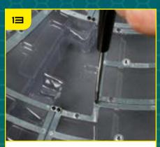
С помощью соединительной накладки с двумя отверстиями соедините угол рамы TF-39 с рамой TF-38.
