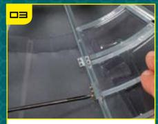
Подденьте край ребра жесткости под кольцо турели и зафиксируйте соединительную накладку на ребре, установленном на раме TF-36.
